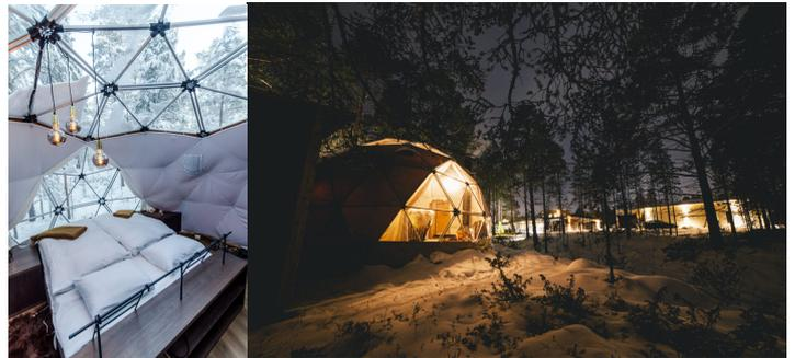
d'un toit extérieur en toile solide sur un cadre en aluminium et d'une couche intérieure plus fine. L'air entre les couches intérieure et extérieure sert d'isolation. Le mur orienté vers le nord et une grande partie du toit sont transparents. La vue magnifique et les sons de la nature donnent l'impression de dormir dehors.
